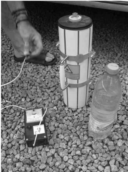
**Le système manuel « waterdrop », qui permet aisément de purifier l'eau dans une bouteille en plastique d'1,5 litre**
